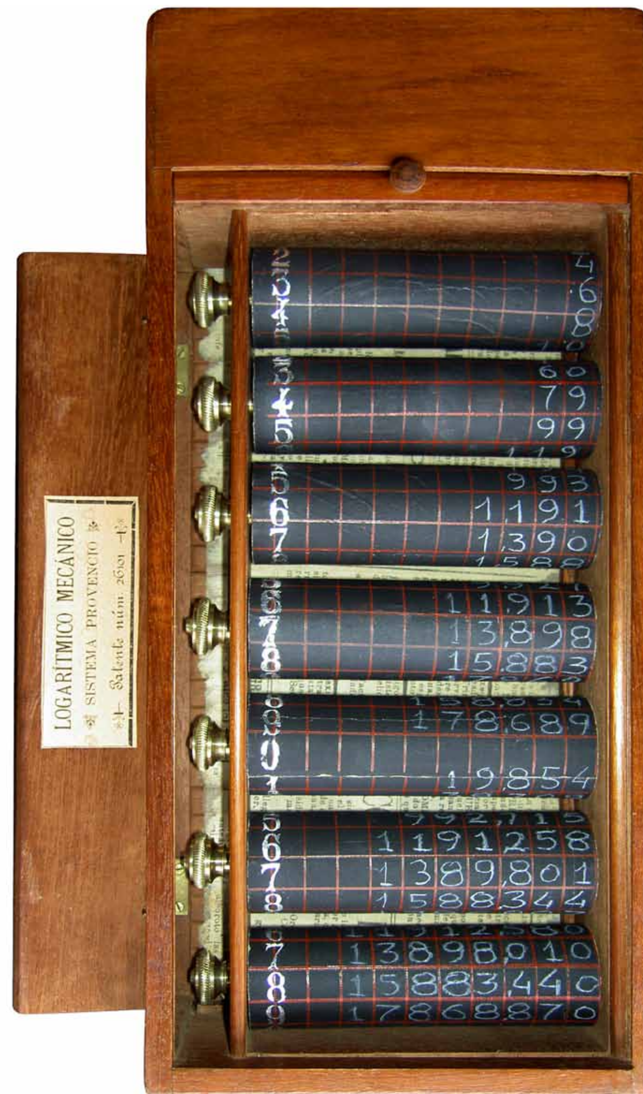
Cilindros inscritos (arriba) y ventanas donde se leen los productos parciales (abajo)
