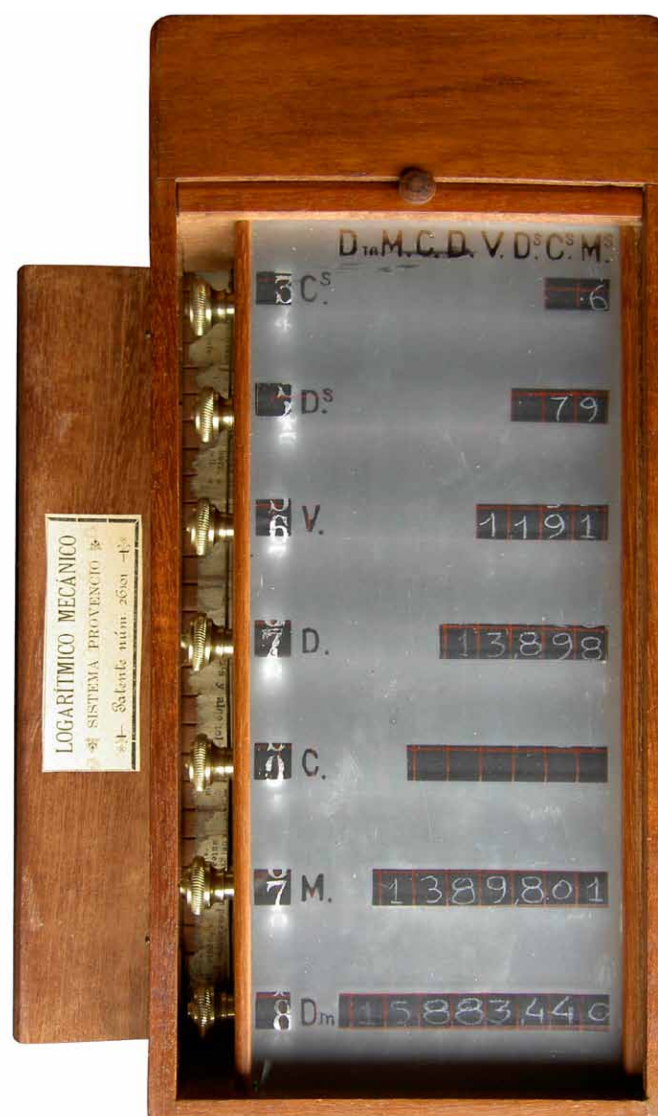
Cilindros inscritos (arriba) y ventanas donde se leen los productos parciales (abajo)
