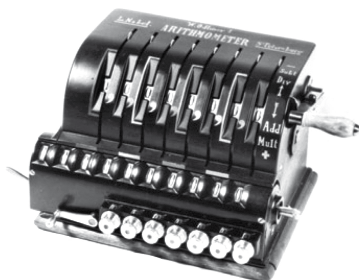
Primera máquina construida por Willgodt T. Odhner en San Petersburgo (Rusia) en el año 1878
