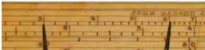
Moltiplicazione con la Gunter's Scale: 2 \times 3 = 6 (© Nathan Zeldes)
