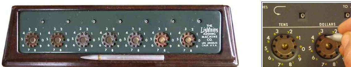
Pascalina del 1940 e sistema per inserire i numeri (la scala gialla serve per sottrarre)
