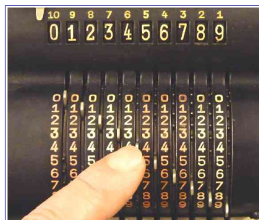
Calcolatrice Odhner e il sistema per inserire i numeri, ca. 1940
