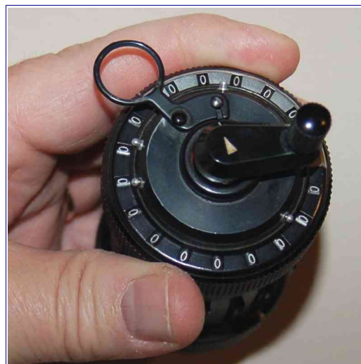
Lo stesso meccanismo nel grande calcolatore del '60 e nella piccolissima Curta
