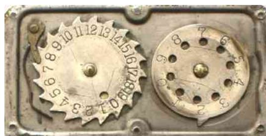
Credit card size: lo Stephenson Adder ed il suo meccanismo, ca. 1890
