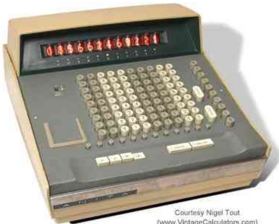
Il primo calcolatore elettronico utilizzabile negli uffici: Bell Punch “ANITA” (A New Inspiration To Arithmetic), 1961
